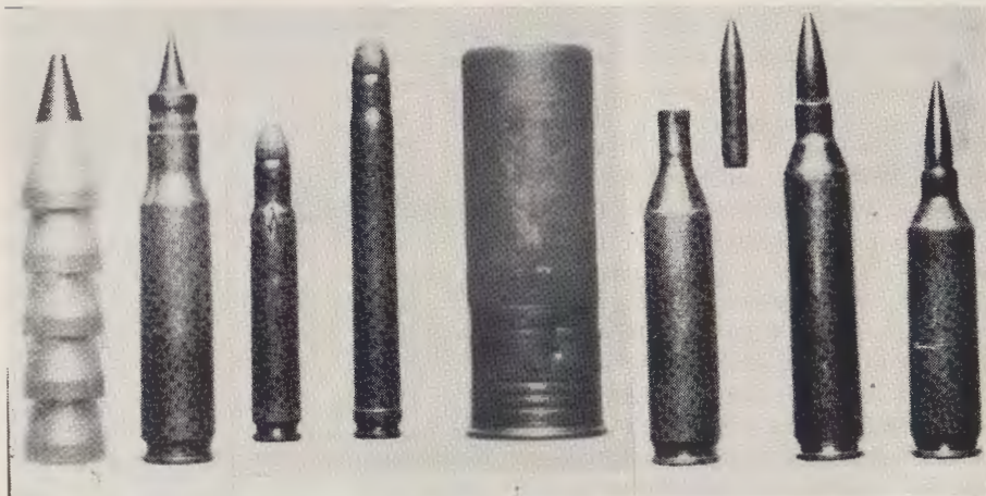
Patruunat vasemmalta oikealle: 12,7 mm — 7,62 mm supistuvalla piipulla ammittava SSB, 7,62 mm — 4,3 mm SSB, SPIW-projektin nuoliluotiset XM 144 ja XM 645 sekä moninuuolinen ja mikrokaliiperiset 3,3 mm:n, 4,3 mm:n ja 4,2 mm:n patruunat. Kolmesta viimeksimainitusta on selvästi todettavissa luodin ja hylsyn normaalista poikkeavat suhteet.
