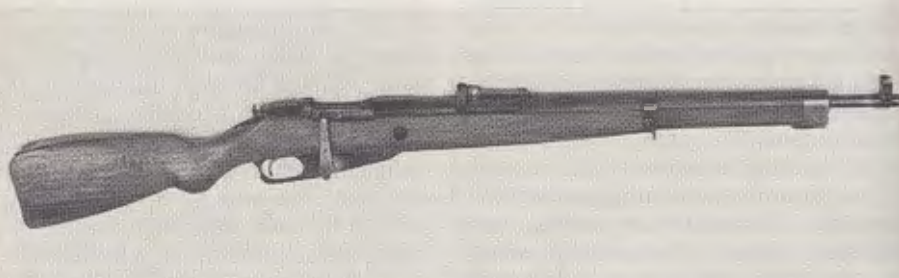
Yleiskiväärin kokeiluihin liittyvän koeaseen m/91/35 kaksi erilaista versiota. Kummassakin on 610 mm:n mittaiseksi lyhennetty m/91:n piippu ja Tähtäinkomitean esittämät tähtäinlaitteet. Ylemmässä kiväärissä on nk. lehtivarmistin sekä venäläisestä tukista jatkamalla tehdyt ratsuväen kiväärin malliset puuosat. Alemmassa tukki on hyvin pitkälle tukkikomitean kehittämää mallia enteillen jo kiväärin m/39 tulemistä.
