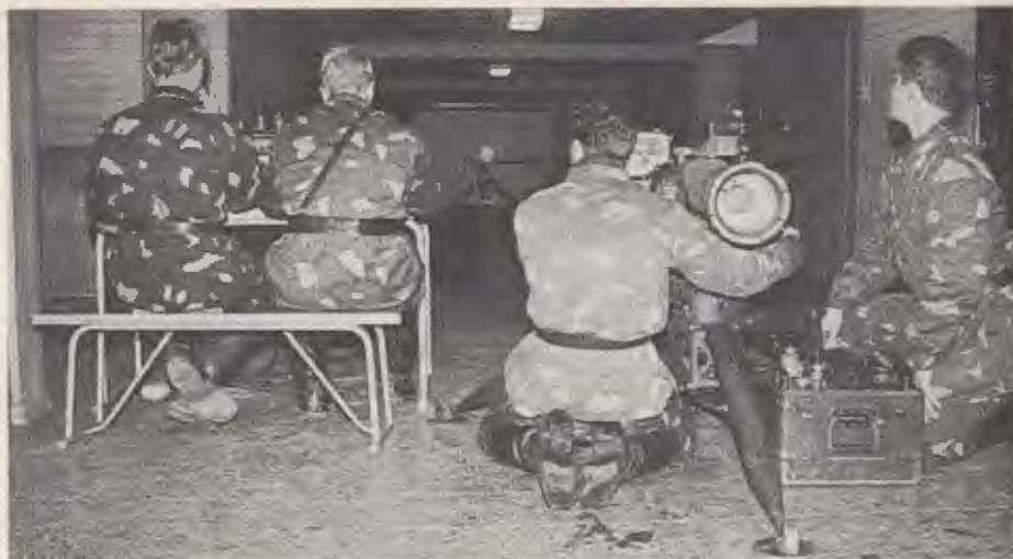
KUVA 2. Panssarintorjuntaohjus 83:n ampujien peruskoulutuksessa käytettävä hallisimulaattori.
