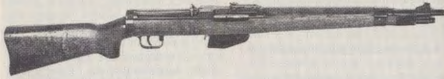
Kotimainen puoliautomaattikiväärin prototyyppi. Aimo Lahden suunnittelema ja Valtion Kivääritehtaan vuonna 1936 valmistama L-36. Aseen edelleenkehittäminen viivästyi kuitenkin nk. karabiinihankkeen vuoksi ja jäi lopullisesti syrjään Talvisodan sytyttyä.
