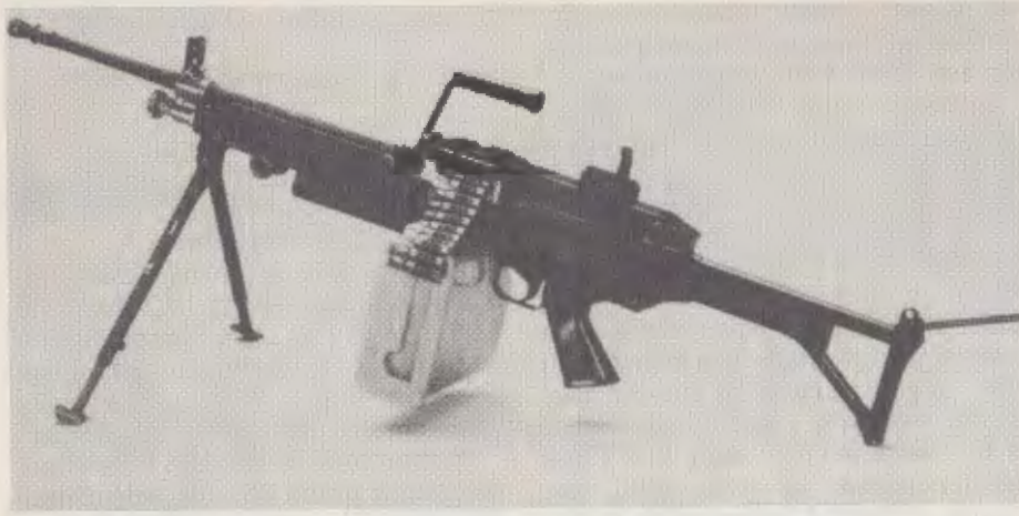
KUVA 13 Belgialainen Minimi konekivääri. Aseen pituus 1.05 m, paino 6.5 kg, tulinopeus 750-1000 ls/min, käyttää Nato-standardin mukaista 5.56x45 SS109 patruunaa, luodin lähtönopeus 915 m/s. Aseella voidaan ampua jatkuvasta vyöstä tai siihen voidaan kiinnittää 200 patruunan läpinäkyvä vyölaatikko. Erikoisuutena mainittakoon mahdollisuus käyttää myös rynnäkkökiväärin lipasta.
