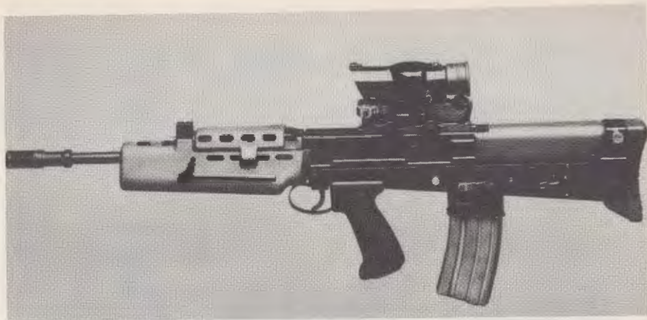
KUVA 10 Englantilainen IW rynnäkkökivääri optisella tähtäimellä varustettuna painaa 4,6 kg. Aseen pituus on 78 cm ja se käyttää 5,56x45 patruunaa, jolla luodin lähtönopeus on 940 m/s.
