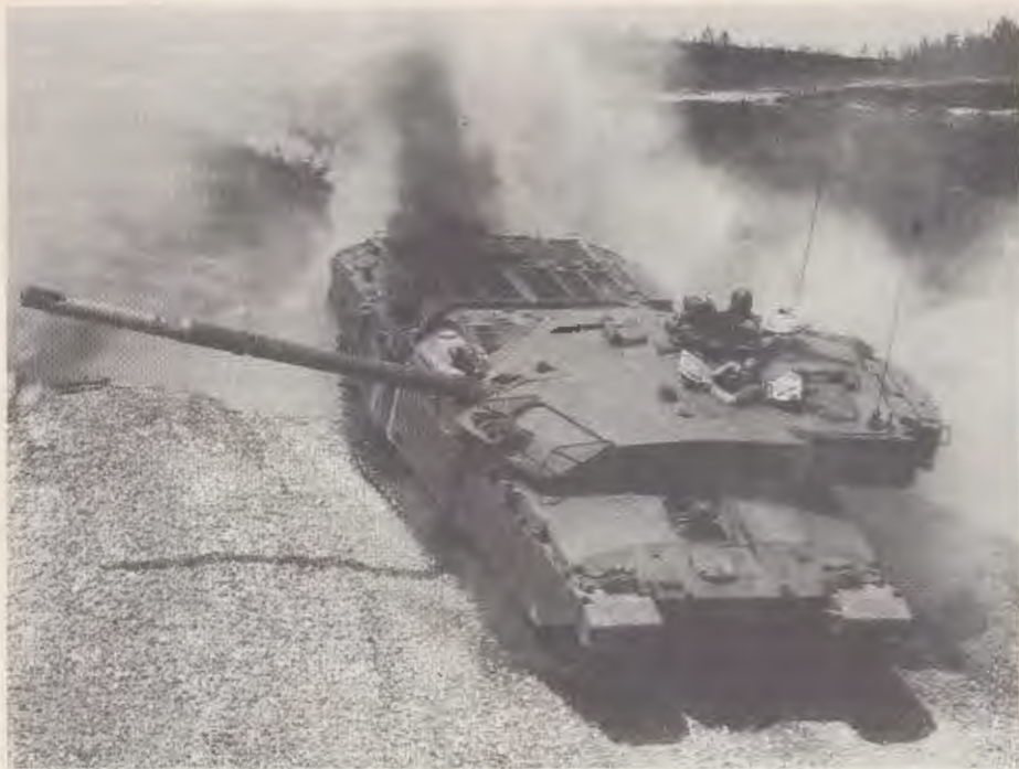
Brittiuutuus Challenger. Chobham-monikerros panssari, 120 mm:n rihlattu panssarivaununukuuna, laseretäisyysmittari, tulenjohtolaskin, lämpökuvatähystysjärjestelmä.
