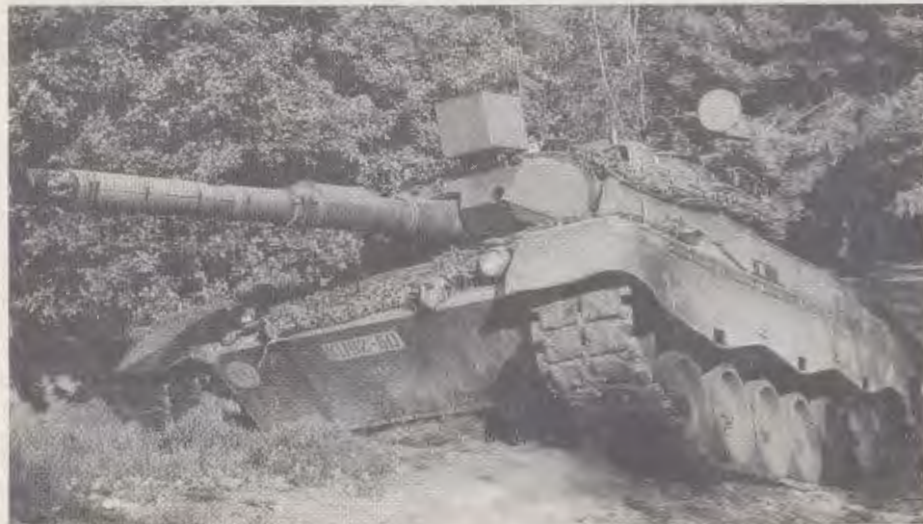
Modernisoitua kalustoa: Hollannin panssarijoukkojen Leopard 1 V tuliasemassa; Parannettu tähtäin- ja tulenjohtojärjestelmä, valonvahvistinlaitteet, tykin lämpösuojus, tornin lisäpanssarointi asekilvessä ja kyljissä.
