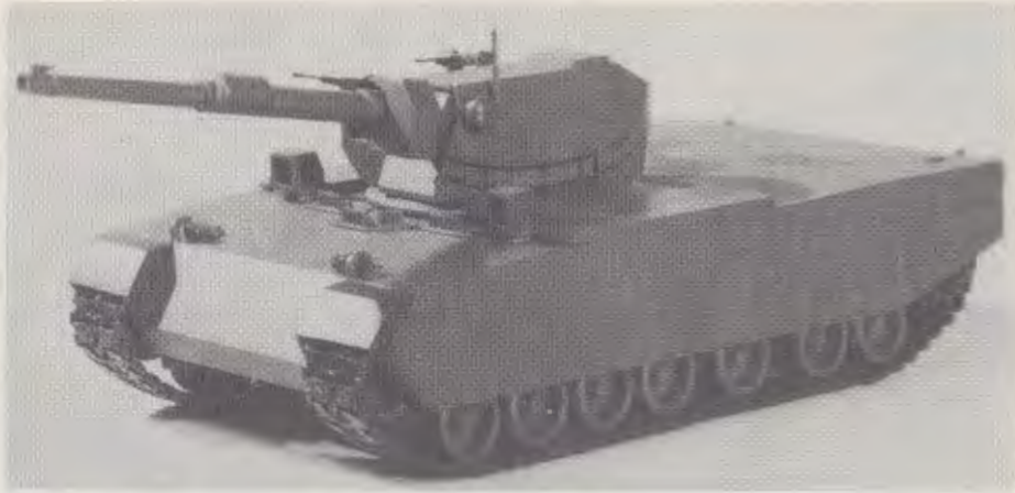
General Dynamics-yhtiön TTB (Tank Test Bed); Miehistötila rungossa, 120 mm:n tykki sijoitettu tähtäimeen erikseen suunnattavaan torniin.
